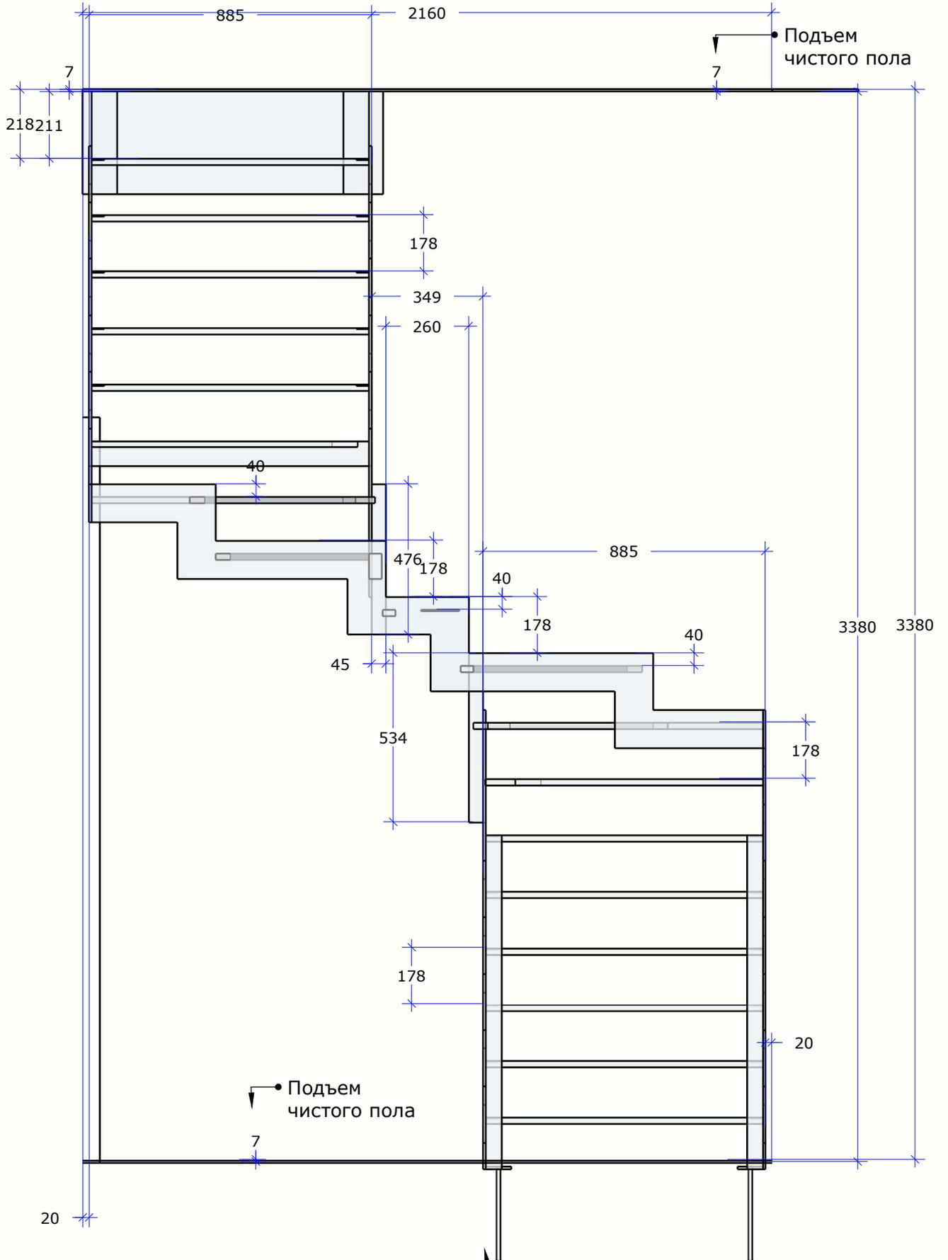
Углубить пластины крепления в стяжку на 20 мм. Арматурой пройти стяжку и зафиксировать в черновой пол. ПО СОГЛАСОВАНИЮ С ЗАКАЗЧИКОМ Т.К. РЯДОМ ТЕПЛЫЙ ПОЛ
